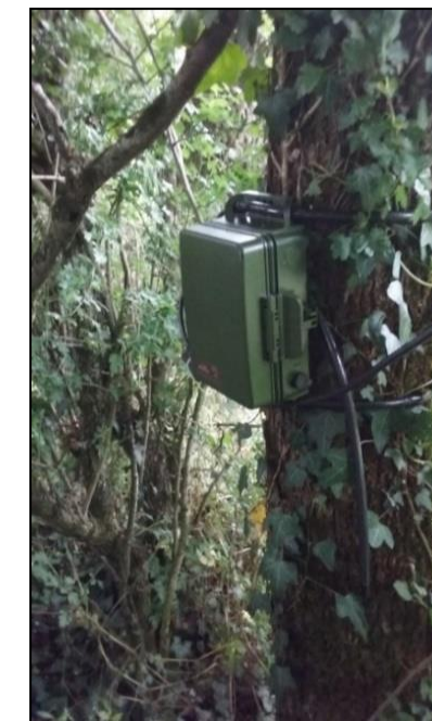
Figure 14 : Exemple d'installation d'enregistreur continu SM4BAT © NCA Environnement, 2020
